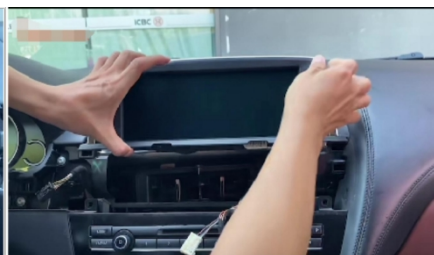
14. Entfernen Sie den Original-Autobildschirm
