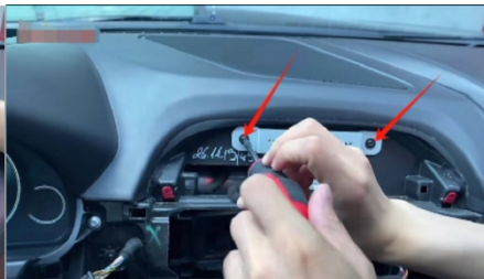
26. Zwei Schrauben aufdrehen
